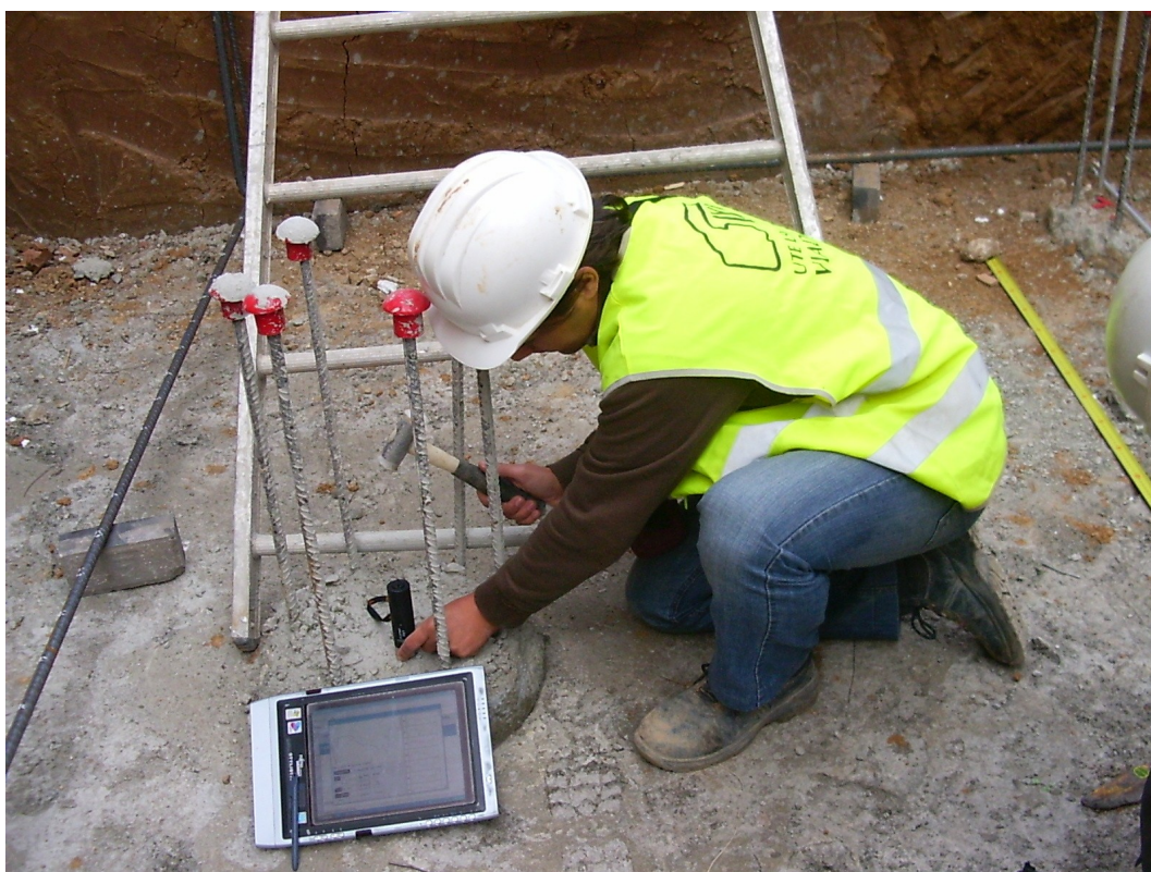
Figura 1: Realización del ensayo sínico con martillo de mano
