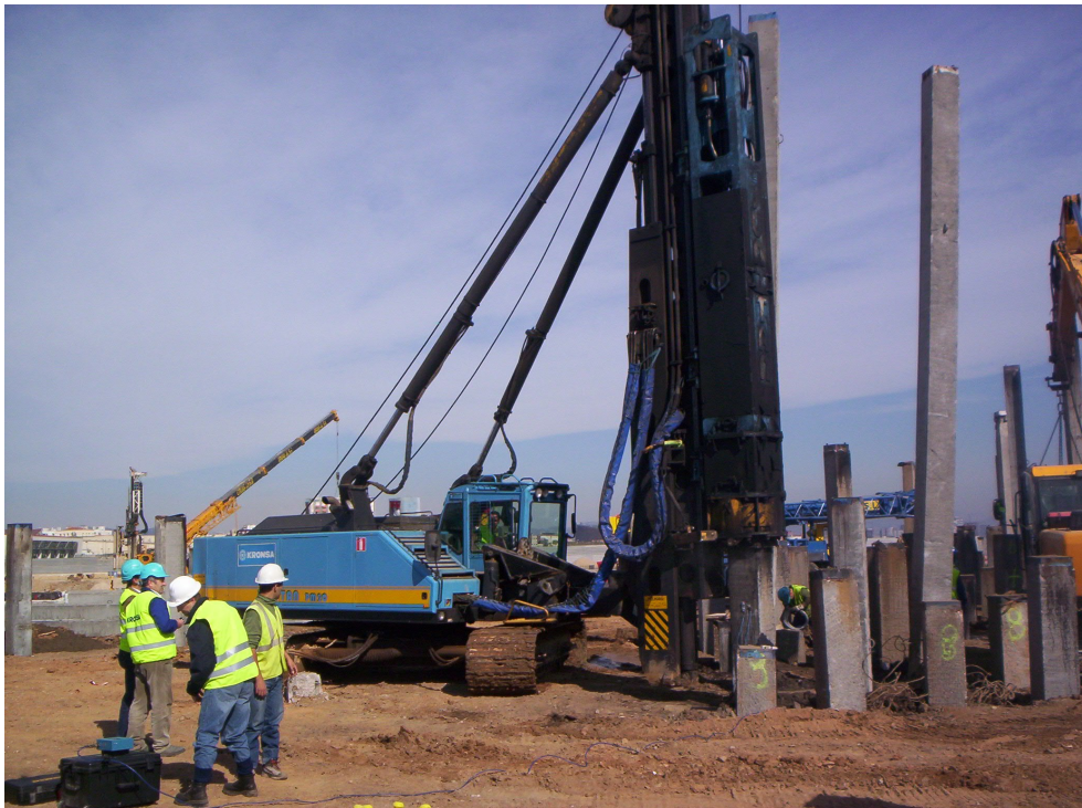
Figura 8: Ensayo dinámico de un pilote
